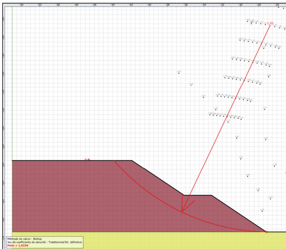
Figure 31 : Résultat du calcul TALREN - Géométrie modifiée du merlon – Banquette intermédiaire - Profil à proximité de l'ouvrage PI10
